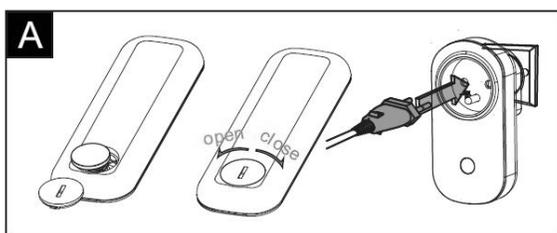
Diaľkový ovládač používa 3V batériu. Zložte kryt na zadnej strane diaľkového ovládania (viac obrázok A) a vložte batériu. Venujte prosím pozornosť symbolom, ktoré označujú polaritu batérie. Diaľkovo ovládanú zásuvku vložte do zásuvky (viď obrázok A).
